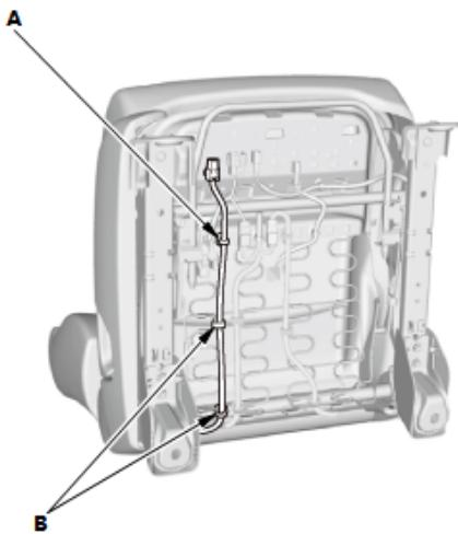
5. 前排座椅靠背护面/软垫 - 拆卸
